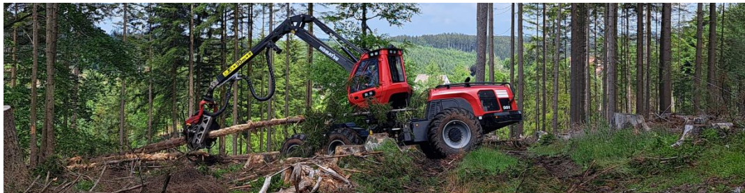
Grafika 13 Prezentacja harwestera z największą dostępną głowicą ścinająco-okrzesującą-przerzynającą oraz gąsienicowej maszyny zrywkowej
