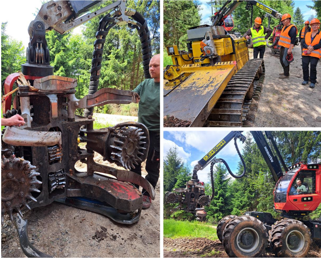
Grafika 13 Prezentacja harwestera z największą dostępną głowicą ścinająco-okrzesującą-przerzynającą oraz gąsienicowej maszyny zrywkowej
